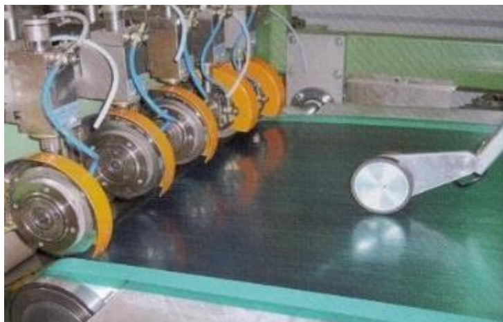
Couteaux de coupe de nappe UD à la sortie du collimateur de 600mm
